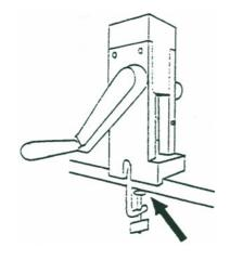
Quetsche ganz an den Tischrand stellen. Quetsche mit der Schraubzwinge am Tisch befestigen. (Bei zu dünner Tischplatte ein kleines Holzbrett zwischen die Schraube und der Tischunterseite einlegen - Pfeil)
