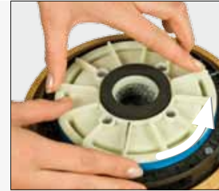
Bild 6 Oberen Stein gegen den Uhrzeigersinn herausdrehen.
