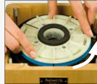
Bild 6 Oberen Stein gegen den Uhrzeigersinn herausdrehen.
