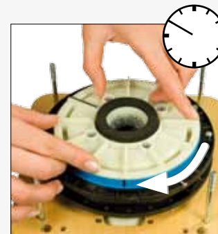
Bild 8 Beachten Sie beim Eindrehen, dass der Mahlstein sich nicht verkantet.
