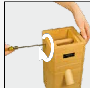
Bild 7 Bremsschraube wieder eindrehen, Leichtgängigkeit des Einstellrades regulieren.
