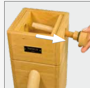
Bild 5 Einstellrad mit Achse seitlich herausziehen.
