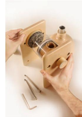
5. Nach der Reinigung den Plexiglaszylinder über den Statorhalter (nicht per Handkurbel angetriebener Stein), Einlauföffnung oben, in die Nut der Holzwand schieben. Dann das Gehäuseteil wieder aufstecken (**Wichtig! Bitte darauf achten, dass der Plexiglaszylinder gleichmäßig in die Nut der Holzwand eintaucht**). Jetzt die Gewindestangen einschrauben und abwechselnd anziehen (nicht zu fest).
