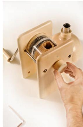
3. Mit einem Inbusschlüssel die beiden Gewindestangen herausdrehen und die Holzteile auseinander schieben
