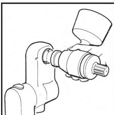
Den Schwenkarm der Küchenmaschine senkrecht nach oben stellen, die Getreidemühle mit der Halterung so an die Maschine drücken, dass die Mitnehmerzapfen an der Mahlwelle in das Antriebsteil eingreifen.
