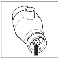
Um bei einer Überlastung der Getreidemühle einen Defekt an Ihrem Grundgerät zu vermeiden, wurde die Mahlwelle (2) mit einer Sollbruchstelle versehen, die bei ca. dreifacher Überlastung bricht.
