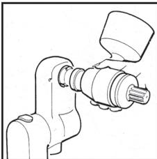
Basculez le bras pivotant de la machine verticalement vers le haut. Insérez l'arbre de meulage du moulin dans le moyeu en vous assurant qu'il puisse s'emboîter dans la partie motrice.
